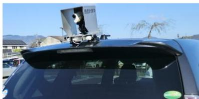
図2 舗装ひび割れ調査状況
