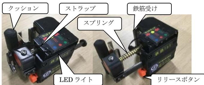
写真-3 鉄筋 IoT（左：縮めた時 右：開いた時）
