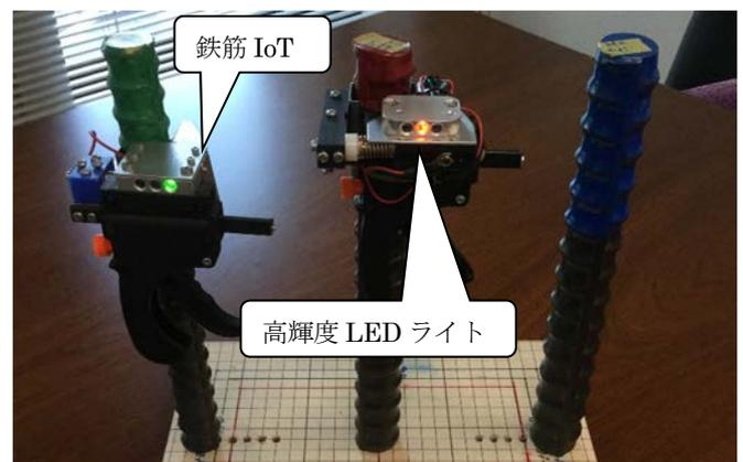
写真-2 鉄筋 IoT
