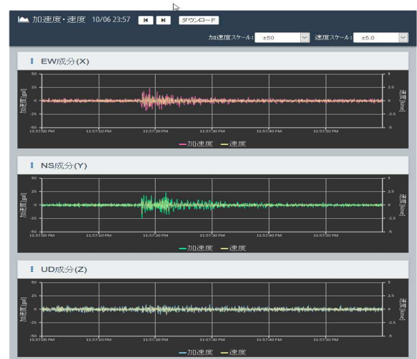
図-3 観測記録（加速度・速度波形：X,Y,Z成分）
