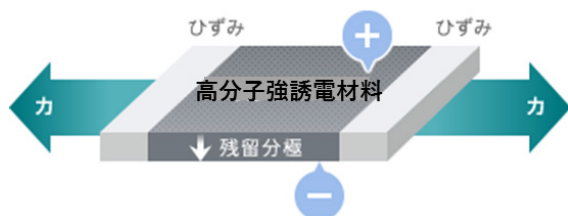
図1 PVDF 圧電のメカニズム
