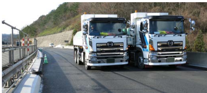
(b) 荷重試験の実験の様子
