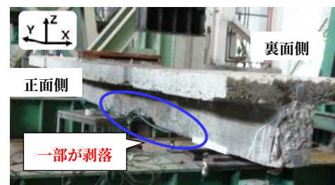
図3 载荷2000回後の試験体
