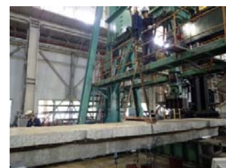
図-3 加振試験の装置図と外観
