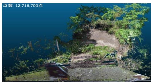
図1 斜面部における TLS と UAV のデータ組合せ
