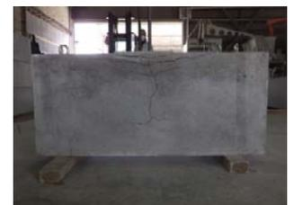
図-8 D16 試験破壊状況
