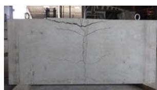
図-9 D16 試験破壊状況
