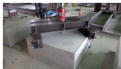
図-4 引抜き試験状況
