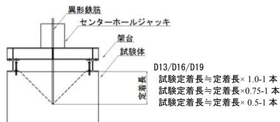
図-3 引き抜き試験概要
