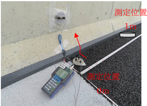
図3 舗装端部における導通経路
