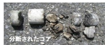
図-2 コア採取時に粉砕された状況
