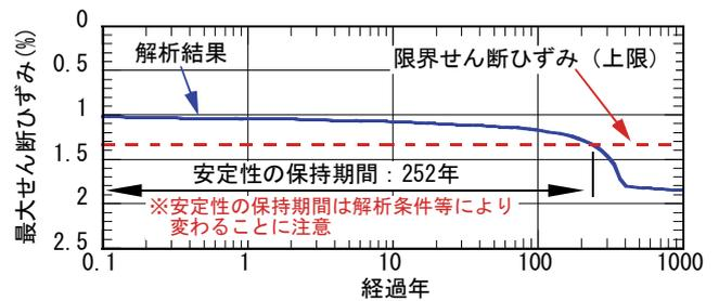
図-4 着目要素における最大せん断ひずみの経時変化
