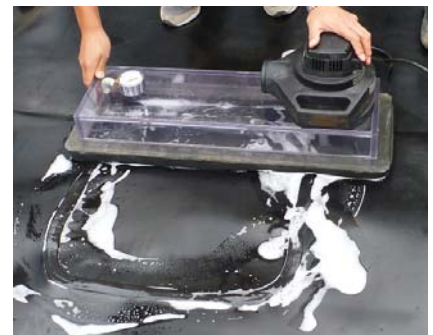
図-3 負圧検査状況
