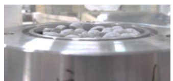
図-1 粒状ベントナイトを供試体リングに充填した時の様子
