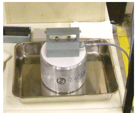
図-2 熱伝導率の測定状況
