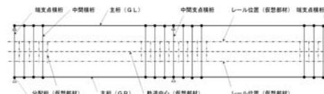
図5 平面格子解析モデル概略図 (例: 横桁間隔700mm, 中間横桁の一部を図から省略)
