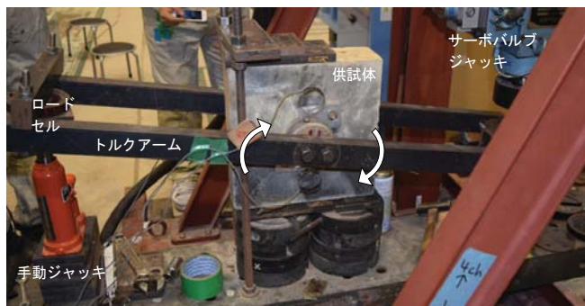
図-2 トルク型せん断試験装置と供試体
