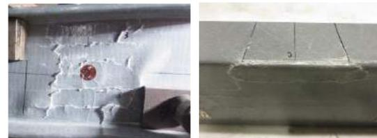
(a) 軸力なし (b) 圧縮軸力 ( $\sigma_n = -80\text{MPa}$ )
