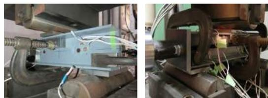
(a) 3点曲げ載荷試験 (b) 圧縮軸力
