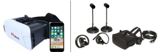
図-2. ハードウェア(左：スマートフォン挿入型、右：HMD 型)
