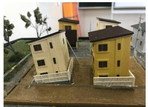
図-7 地盤の液状化
