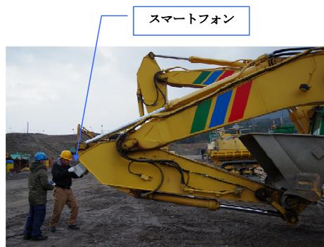
図2 センサの取り付け状況
