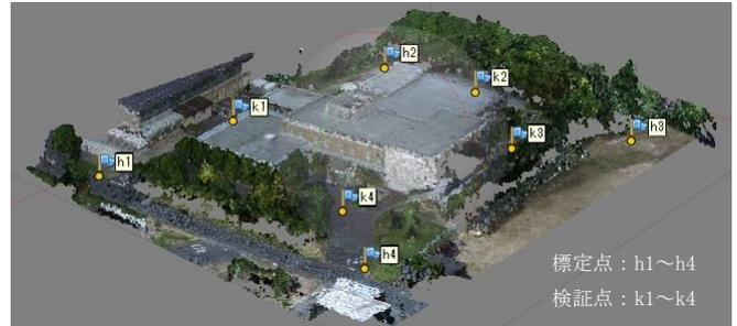
図-1 UAV を用いた空撮写真による 3 次元点群
