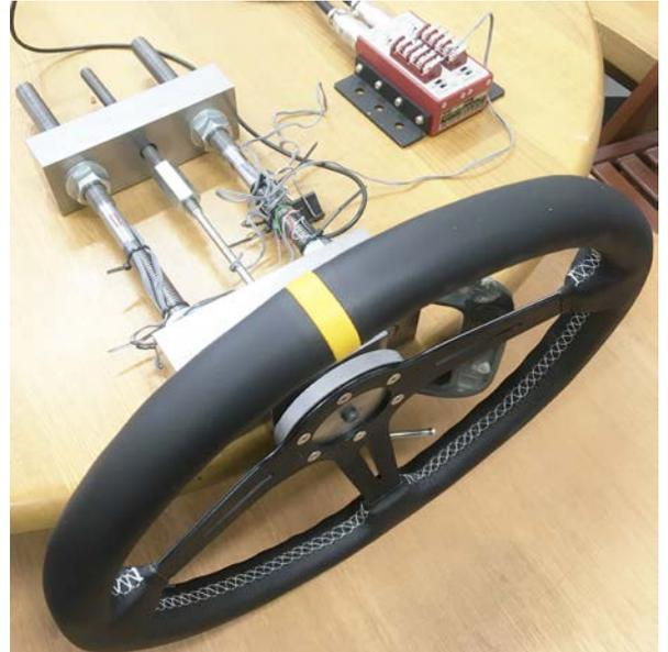
写真-1 ステアリングホイールを用いた改良機
