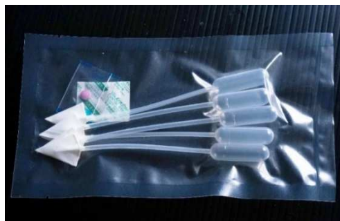
図2 保存中の間隙水採取スポイト
