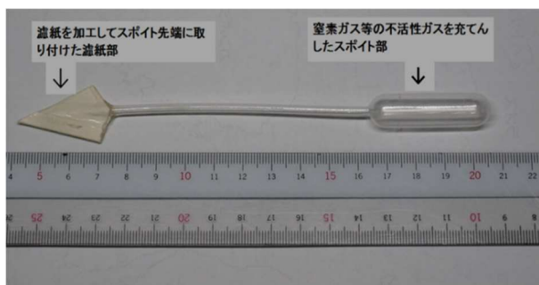
図1 間隙水採取スポイト(特許出願中)
