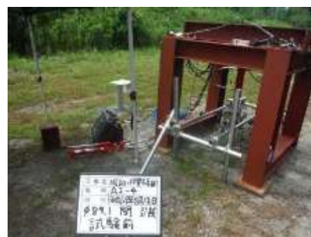
写真3 引抜載荷試験状況
