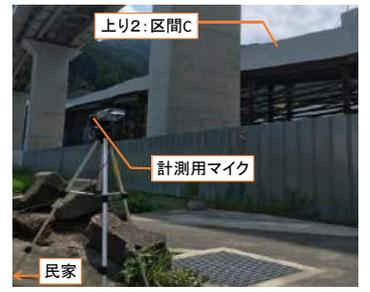
写真-1 走行経路と計測マイクの配置
