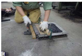
写真-3 打継目部作製状況
