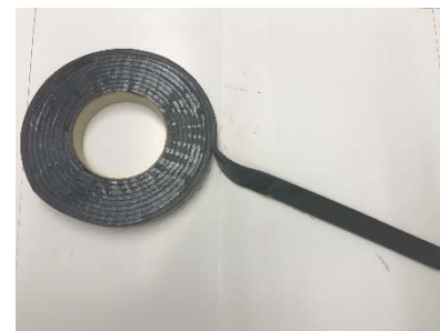
写真-2 短冊形遮水シール
