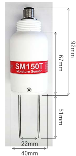
図 1 誘電率計寸法
