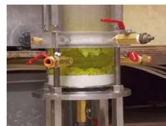
写真2 Case2(特殊シール材)浸透状況
