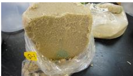
図3 ビーカー試験結果(孔壁崩壊)
