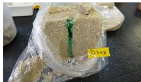
図4 ビーカー試験結果(孔壁保持)
