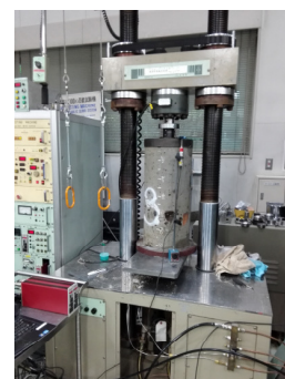
写真-2 φ300mm コアの一軸圧縮試験状況
