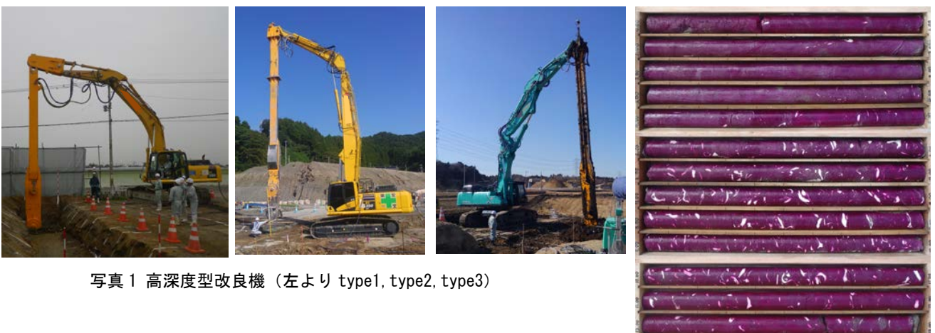
写真 2 全長コアボーリング（フェノール散布）
