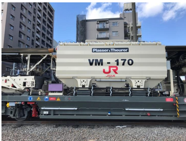
写真④ 真空タンク
