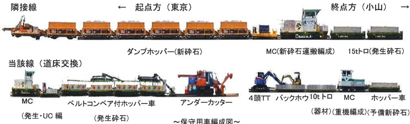
交換現場の保守用車編成は、上記編成図に示すように、隣接線に新砕石運搬等の保守用車編成、道床交換の当該線に発生砕石運搬車(ベルトコンベア付ホッパー車)及びアンダーカッターを連結した保守用車編成、その後続に4頭 TT バックホウとバックホウ及び予備の新砕石を積んだ保守用車編成からなる。
