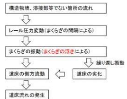
図-1. 道床流れ発生メカニズムの仮説 1)
