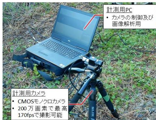
図 1 微小変位測定システム
