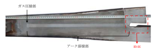
図-2 可動レール部
