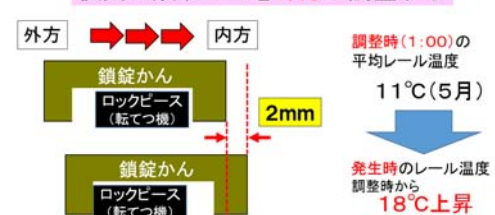
図-2 転てつ機内部の鎖錠かんの動き
