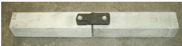
図 1 弾性継手の組立状況
