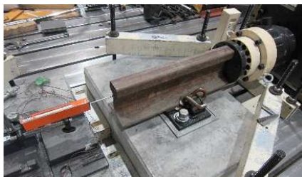
図4 レール締結装置疲労試験装置による試験
