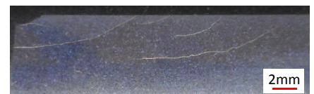
図 4 き裂進展状況
