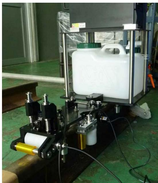
写真1 新型レール探傷装置
