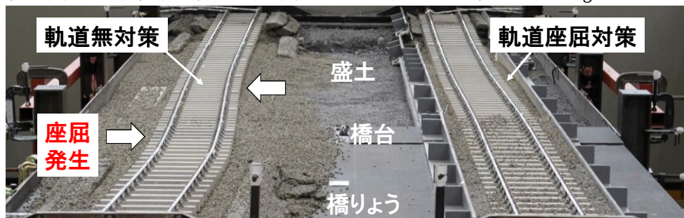
図8 加振後の状況(正弦波700gal後)
