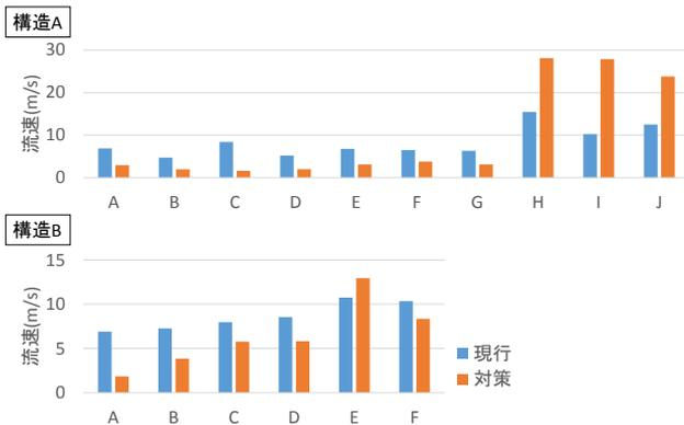
図7 流速の測定結果(流速270km/h,中央)
