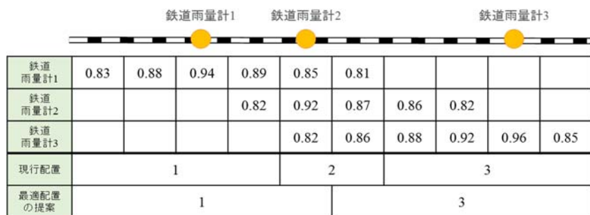
図-3 解析雨量と鉄道雨量計との相関例
