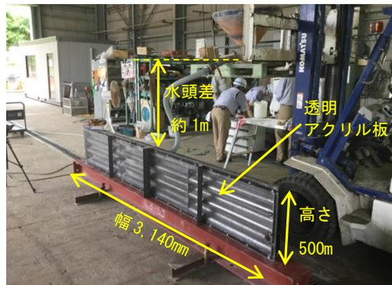
写真-1 試験体 (流動性確認試験)
