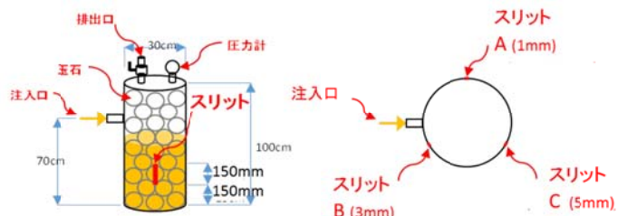
図-2 模型注入試験（円柱モールド注入試験）模式図
