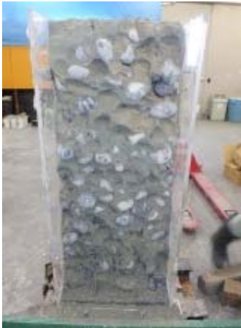
写真-3 可塑性グラウト充填状況
