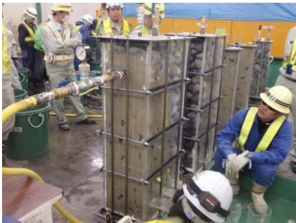
写真-2 模型注入試験（角柱モールド注入試験）施工状況
