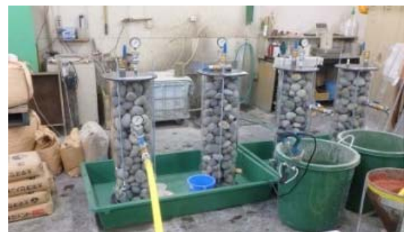
写真-1 模型注入試験（円柱モールド注入試験）施工状況
