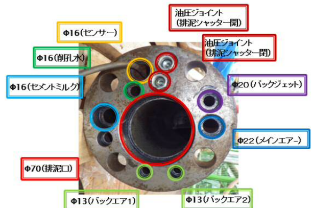
写真-1 多孔管ロッド(断面)
