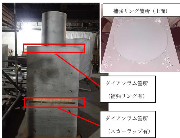
図-4 脱型後の試験体
